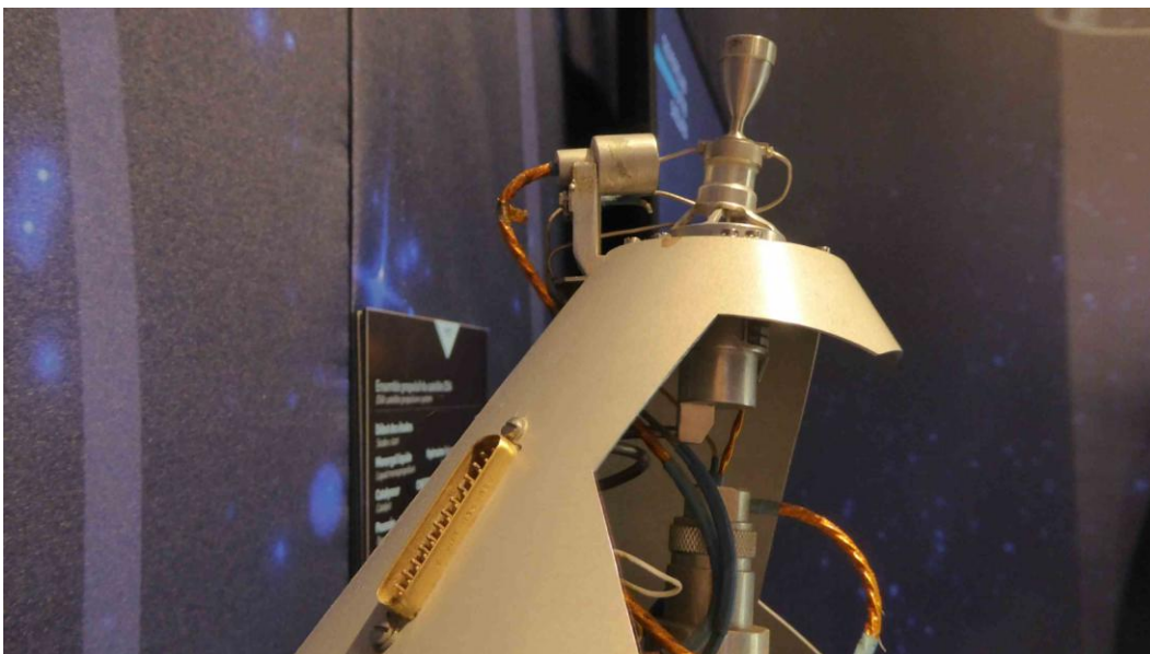
Ensemble propulsif du satellite D5A (1971), poussée entre 3.3 N et 1.8 N
